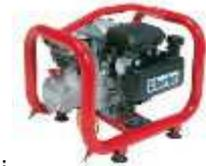
El PPET2 es un compresor más potente proporcionando una fuente de aire 145psi / 10 bar con almacenamiento de aire de 6 litros. Esta unidad es compacta (520 x 445 x 435 mm) y pesa 24 kg. Este compresor permite el muestreo a profundidades de hasta alrededor de 100 metros.
