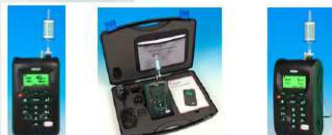
Analizador portátil específicamente diseñado para el control de seguridad, detección de fugas y monitorización de exposición del personal médico al N<sub>2</sub>O ( también conocido como protóxido de nitrógeno, óxido de nitrógeno”) 0-1.000 ppm.
